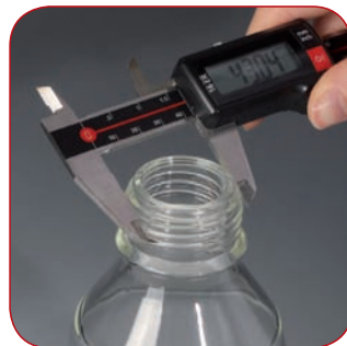
Gewindemessung an einer Flasche
