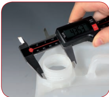
Gewindemessung an einem Kanister
